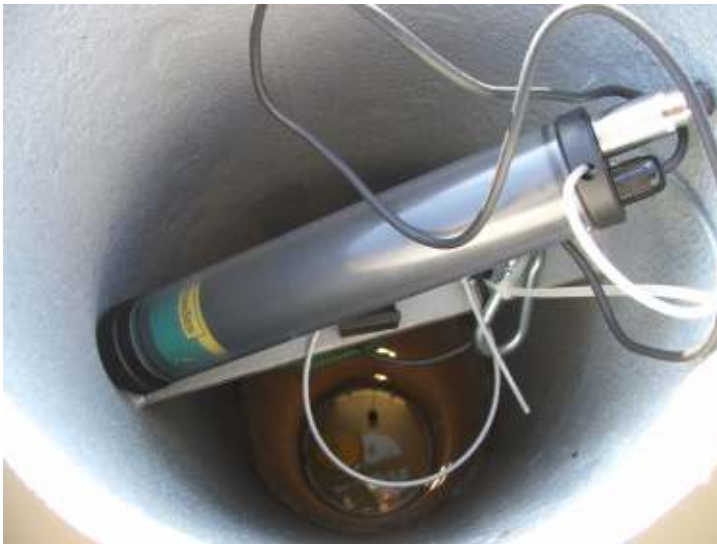
תמונה 3 : מד מפלס רציף מסוג טלימדס המבוסס על מצוף, גלגלת ומכשיר רושם נתונים.
